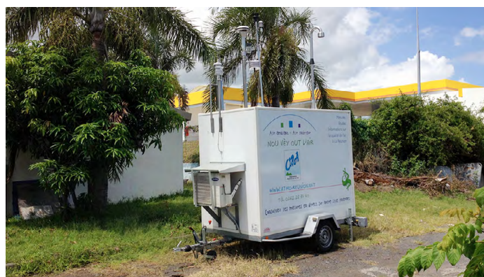
Exemple de laboratoire mobile de mesure de l'air. © Atmo Réunion
